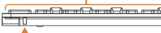
● **LED** Светодиод мигает при обнаружении устройства компьютером. Светодиод горит при стандартной работе устройства.
