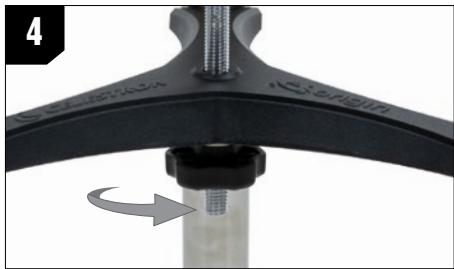
**4.** Schrauben Sie die Mutter mit der Unterlegscheibe wieder auf die Gewindesäule und ziehen sie fest an. Die Stativbeinstütze darf sich nicht gegen das Stativ bewegen.
