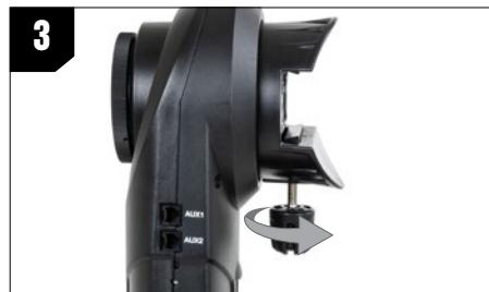
3. Afloje el mando de liberación rápida un par de vueltas para dejar espacio para el machihembrado del tubo Origin.
