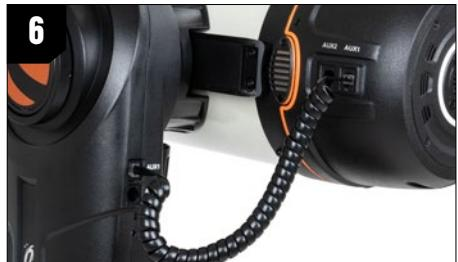
6. Stecken Sie das AUX-Kabel vom Anschluss auf der Rückseite des Origin Tubus in den AUX-Anschluss an der schmalen Seite der Montierung.
