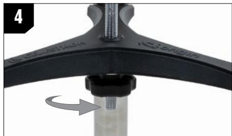
4. Vissez la molette avec la rondelle dans la colonne et serrez fermement. L'entretoise de pied de trépied ne doit pas pouvoir se mouvoir contre le trépied.
