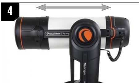
4. Fare scorrere delicatamente il tubo di poco in avanti o indietro per bilanciare il telescopio e serrare la manopola di rilascio rapido per fissarlo in posizione.
