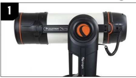
1. Halten Sie den Origin Tubus von unten fest, damit er nicht plötzlich nach oben oder unten rutscht, lösen Sie den Höhenkupplungsknopf und lassen den Tubus vorsichtig los. Wenn Ihr Origin richtig ausgerichtet ist, sollte der Tubus in einer horizontalen Position bleiben, wenn der Kupplungsknopf gelöst wird. Wenn dies der Fall ist, können Sie mit dem nächsten Abschnitt der Anleitung fortfahren. Wenn sich der Tubus nach oben oder unten bewegt, machen Sie mit Schritt zwei weiter.
