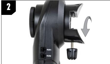
2. Drehen Sie die Höhenachse so lange, bis der Schnellspannknopf nach unten zeigt. Ziehen Sie dann den Feststellknopf der Höhenverriegelung wieder fest.
