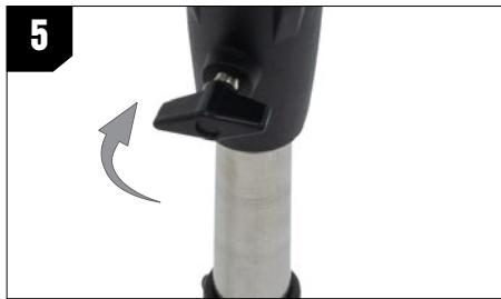
**5.** Stellen Sie die Stativhöhe ein, indem Sie die Feststellknöpfe am Ende jedes Stativbeins lösen. Passen Sie dann die Beinhöhe nach Bedarf an und ziehen dann die Feststellknöpfe an einem Bein nach dem anderen wieder fest. Beachten Sie, dass Sie die Markierungen an den Beinen verwenden können, um das Stativ einfach auszurichten.
