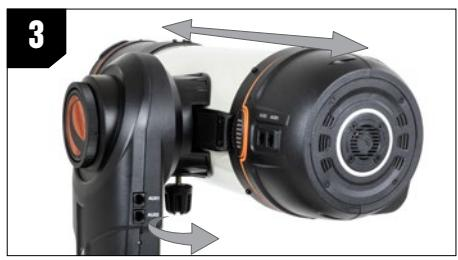
3. Stützen Sie das Gewicht des Tubus mit einer Hand ab und lösen vorsichtig den Schnellspannknopf des Teleskops, damit es auf der Prismenschiene gleiten kann.
