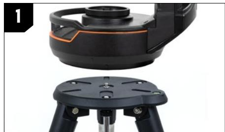
**1.** Sistemare la montatura del braccio a forcella sul perno centrale sulla testa del treppiede. Non lasciare andare la montatura finché non è collegata al perno centrale. La montatura non deve oscillare.
