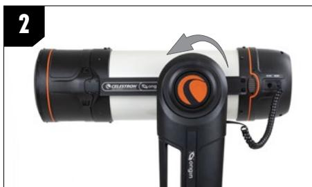
2. Allentare la manopola di regolazione dell'altitudine e ruotare il tubo Origin fino a quando sarà parallelo al pavimento. Serrare la manopola di regolazione.
