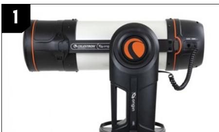
1. Mantenendo il tubo Origin da sotto in modo che non possa inclinarsi improvvisamente verso l'alto o verso il basso, allentare la manopola di regolazione dell'altitudine e rilasciare con cautela il tubo. Se correttamente bilanciato, il telescopio Origin deve rimanere in posizione orizzontale quando viene allentata la manopola di regolazione. Se ciò avviene, passare alla sezione successiva della presente guida. Se il tubo si muove verso l'alto o il basso, passare al punto due.
