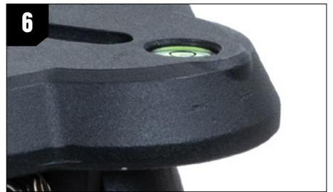
**6.** Bestätigen Sie mithilfe der integrierten Wasserwaage am Stativkopf, dass das Stativ waagrecht ausgerichtet ist.
