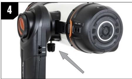
4. Faites glisser le tube optique Origin dans l'encoche de libération rapide, depuis l'arrière du télescope. Le bras de fourche doit se trouver sur le côté gauche du tube optique.
