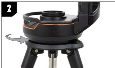
**2.** Con la montatura poggiata sulla testa del treppiede, ruotare la montatura fino a quando le tre prese di montaggio sono allineate. Le prese scatteranno in posizione, ciò indicherà che sono allineate.
