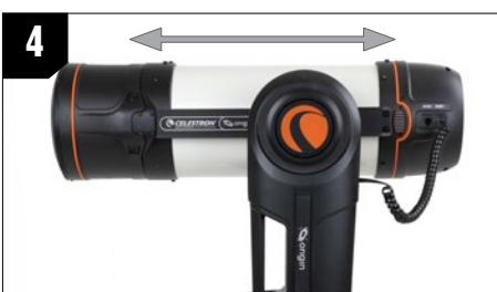
4. Schieben Sie den Tubus vorsichtig ein wenig nach vorne oder hinten, um das Teleskop auszubalancieren und ziehen dann den Schnellspannknopf fest, um es zu befestigen.
