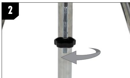
**2.** Nehmen Sie Mutter und Unterlegscheibe von der Mittelsäule am Stativkopf ab.
