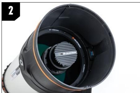
2. Saque el soporte de la cámara de espuma del interior del parasol de la lente tirando recto hacia fuera. Esta espuma ha sido diseñada para proteger la cámara durante el transporte. No necesita volver a instalarla cada vez que guarde su Origin. Sin embargo, recomendamos que conserve esta espuma y la use sin enviar Origin en su embalaje original.
