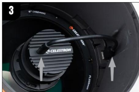
3. Conecte el extremo del cable de cámara USB al puerto de la parte posterior de la cámara.
