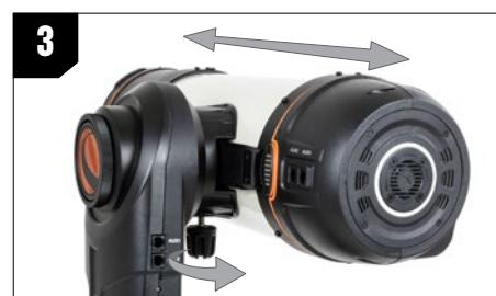
3. Supportez le poids du tube d'une main et desserrez doucement la molette de libération rapide du télescope pour lui permettre de glisser sur la barre à queue d'aronde.
