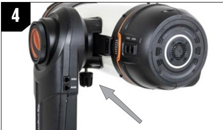
4. Schieben Sie den Origin Tubus von der Rückseite des Origin in den Schnellverschlusschlitz. Der Gabelarm sollte sich auf der linken Seite des optischen Tubus befinden.
