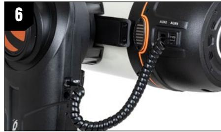
6. Conecte el cable AUX del puerto de la parte posterior del tubo Origin al puerto AUX del lado estrecho del soporte.
