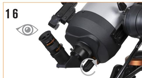
Nehmen Sie den Objektivdeckel vorne am Teleskop ab. Schauen Sie zum Beobachten durch das Okular, wie oben dargestellt. Stellen Sie das Bild scharf, indem Sie den Knopf unter dem Okular und diagonal drehen.
