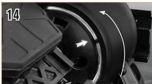
14 Allineare la freccia sull'aggancio con il segno presente sulla montatura e premere verso l'interno ruotando contemporaneamente in senso antiorario l'aggancio fino a quando il pulsante di rilascio arancione scatta in posizione sul foro dell'aggancio.
