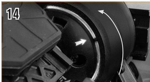
14 Alinee la flecha del conector con la marca de alineación del soporte y presione hacia dentro girando el conector en sentido contrario a las agujas del reloj hasta que el botón de liberación naranja encaje en posición en el agujero del conector.
