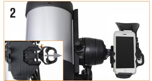
Abra el deslizador de muelle de la parte superior del conector del teléfono y coloque el teléfono en el soporte de forma que quede llano con el borde inferior del soporte del teléfono. Suelte lentamente el deslizador para asegurar el teléfono en posición. La mayoría de teléfonos caben en el conector con la funda puesta. Sin embargo, puede que tenga que sacar la funda del teléfono si es especialmente voluminosa o no encaja en la fijación (por ejemplo, fundas con tapa).
