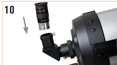
10 Inserire il barilotto dell'oculare da 25 mm nel diagonale e serrare la vite.
