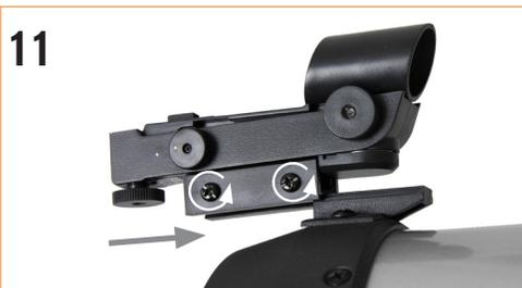
11 Allentare le due viti con testa a croce sul lato del mirino e far scorrere il mirino sulla coda di rondine di montaggio sulla parte superiore del tubo del telescopio. La grande finestra sul mirino dovrebbe essere rivolta verso la parte anteriore del telescopio. Fissare la staffa serrando le viti con testa a croce sul lato del cercatore.
