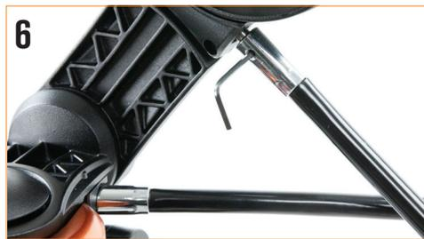
Installez la molette de contrôle de mouvement ralenti sur le moyeu d'engrenage en D et appuyez dessus pour vous assurer qu'elle est complètement enfoncée. Utilisez la clef hexagonale pour serrer les vis de fixation sur la tige de l'engrenage. Remettez la clef hexagonale dans son logement sur l'avant de la monture.
