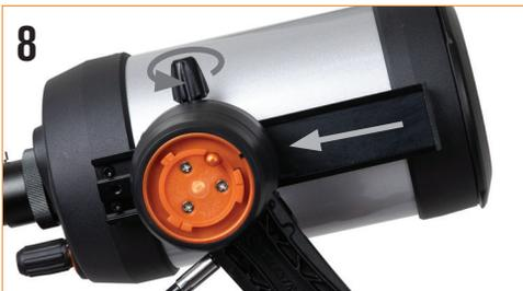
8 Fare scorrere la barra a coda di rondine nel fermo sulla sommità della montatura e serrare la manopola manuale sulla parte inferiore del fermo per fissare il telescopio in posizione.
