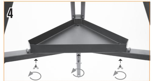
Placez le plateau à accessoires sur le dessus de l'entretoise centrale et alignez les trois trous. Insérez les trois vis à main dans le dessous de l'entretoise et vissez-les dans le plateau.
