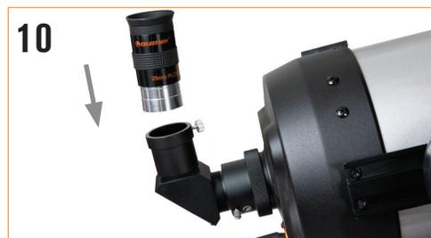
Introduzca el cañón del ocular de 25 mm en la diagonal y apriete el tornillo.
