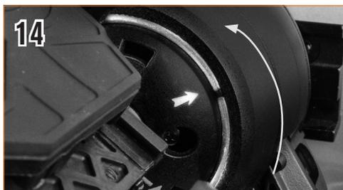
Richten Sie den Pfeil auf dem Dock mit der Ausrichtungsmarkierung auf der Montage aus und drücken Sie das Dock nach innen, während Sie es gegen den Uhrzeigersinn drehen, bis der orangefarbene Entriegelungsknopf in der Öffnung am Dock einrastet.
