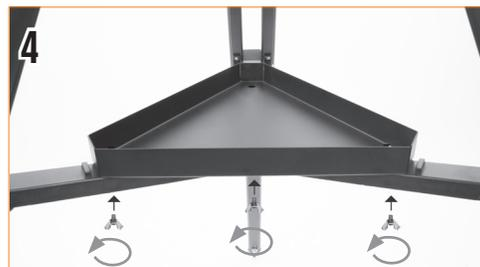
4 Posizionare il vassoio porta accessori sopra il supporto centrale e allineare i tre fori. Inserire le tre viti ad alette attraverso la base del supporto delle gambe e avvitarle nel vassoio.
