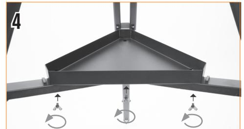
4 Platzieren Sie die Zubehörablage oben auf der mittleren Stützstrebe und richten Sie sie mit den drei Löchern aus. Führen Sie die drei Rändelschrauben durch die Unterseite der Beinstrebe und schrauben Sie sie in die Ablage.
