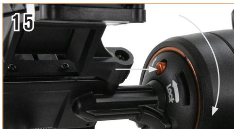
Drücken Sie zum Entfernen des Docks den orangefarbenen Entriegelungsknopf und drehen Sie das Dock im Uhrzeigersinn, bis sich der Bajonetverschluss löst.
