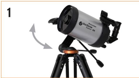
El soporte StarSense Explorer DX tiene fijaciones deslizantes en ambos ejes. Para realizar movimientos de gran tamaño con el telescopio, aguarde una pata del trípode con una mano y use la otra mano en el tubo del telescopio para empujar el telescopio en la dirección deseada.
