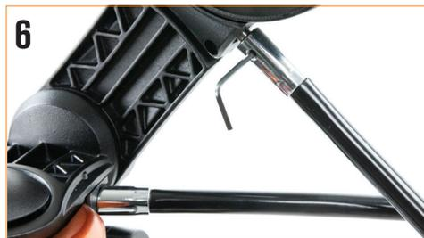
6 Setzen Sie den Feineinstellungsregler auf die D-förmige Getriebewelle und drücken Sie ihn nach innen, um sicherzustellen, dass er fest sitzt. Ziehen Sie die Stellschrauben mit dem Inbusschlüssel auf der Getriebewelle fest. Stecken Sie den Inbusschlüssel wieder in seinen Aufbewahrungsort auf der Vorderseite der Montierung.
