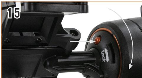
15 Para sacar el conector pulse el botón de liberación naranja y gire el conector en el sentido de las agujas del reloj hasta que el soporte de bayoneta se suelte.
