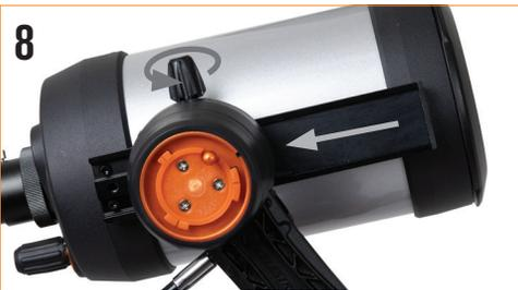
Faites glisser la barre à queue d'aronde dans le rail situé sur le dessus de la monture et serrez la molette à main située sur le dessus du rail pour fixer le télescope en place.
