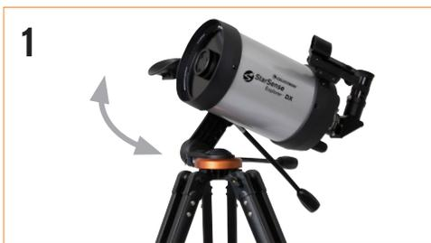
La monture StarSense Explorer DX dispose de freins de mouvement sur chaque axe. Pour effectuer de larges mouvements avec le télescope, tenez simplement un pied du trépied d'une main, et de l'autre, poussez le tube du télescope dans la direction opposée.
