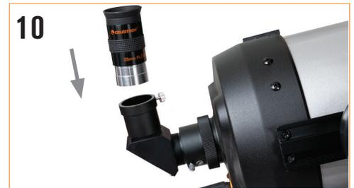
Insérez le barillet de l'oculaire de 25 mm dans le renvoi coudé et serrez les vis.
