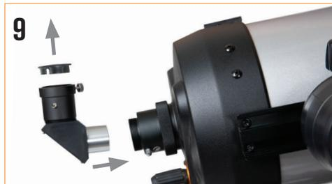
9 Nehmen Sie den Zenitspiegel für aufrechtes Bild und entfernen Sie die Kunststoffabdeckungen. Setzen Sie die Lauf der Diagonale in die Rückseite des Teleskoprohrs ein und sichern Sie ihn durch Anziehen der Stellschrauben.
