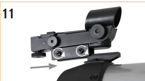
Lösen Sie die beiden Kreuzschlitzschrauben an der Seite des Sucherfernrohrs und schieben Sie das Sucherfernrohr auf den Schwalbenschwanz oben am Teleskoprohr. Das große Fenster am Sucher sollte zur Vorderseite des Teleskops zeigen. Befestigen Sie die Halterung, indem Sie die Kreuzschlitzschrauben an der Seite des Sucherskops festziehen.
