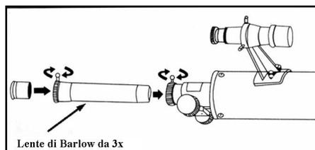
Il telescopio è dotato anche di una lente di Barlow da 3x che triplica la potenza di ingrandimento di ciascun oculare. Tuttavia, le immagini molto ingrandite vanno usate solo in condizioni ideali (vedere la sezione "Calcolo dell'ingrandimento" di questo manuale). Per usare la lente di Barlow, rimuovere il diagonale e inserire la lente di Barlow direttamente nel tubo del focalizzatore. Per eseguire la visualizzazione si inserisce quindi un oculare nella lente di Barlow.
