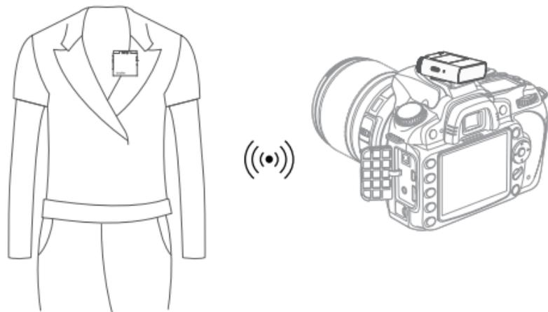
1. 将全向型领夹式麦克风插入发射器的3.5mm音频输入接口, 用背夹将发射器夹在腰带上。或直接使用发射器内置麦克风, 用背夹将发射器夹在衣领上。
