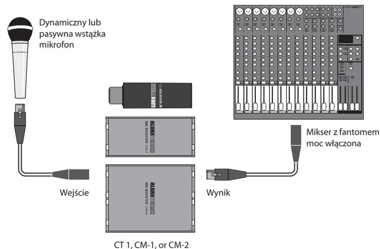
\*uwaga - CT 1 można również podłączyć bezpośrednio do większości mikrofonów
