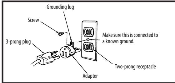
**WARNING: THE GREEN GROUNDING LUG EXTENDING FROM THE ADAPTER MUST BE CONNECTED TO A PERMANENT GROUND SUCH AS TO A PROPERLY GROUNDED OUTLET BOX. NOT ALL OUTLET BOXES ARE PROPERLY GROUNDED.**
