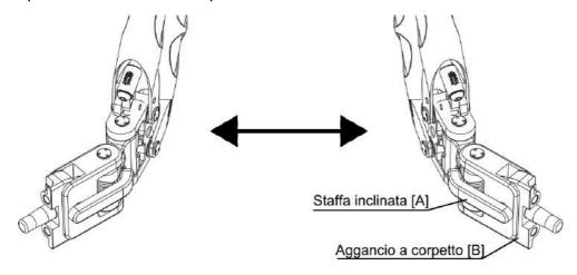
Svitare con la chiave in dotazione la vite che tiene il mating block serrato al resto del braccio. Estrarre la staffa inclinata (A) che precarica la molla torsionale presente nello snodo a ridosso del mating block. Girare il verso dell'aggancio a corpetto (B) e riassmblare la staffa inclinata [A] dal lato opposto a quello precedente. A questo punto tenendo con una mano lo snodo leggermente inclinato secondo il verso della staffa, inserire la vite e serrare il mating block .
