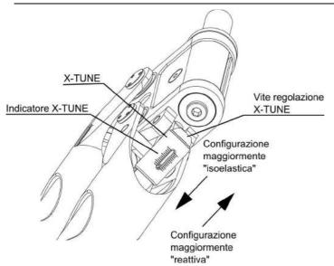
Il braccio di stabilizzazione ARM X1 di SmartSystem è dotato di un esclusivo sistema di regolazione del comportamento dinamico del braccio stesso denominato X-TUNE.
