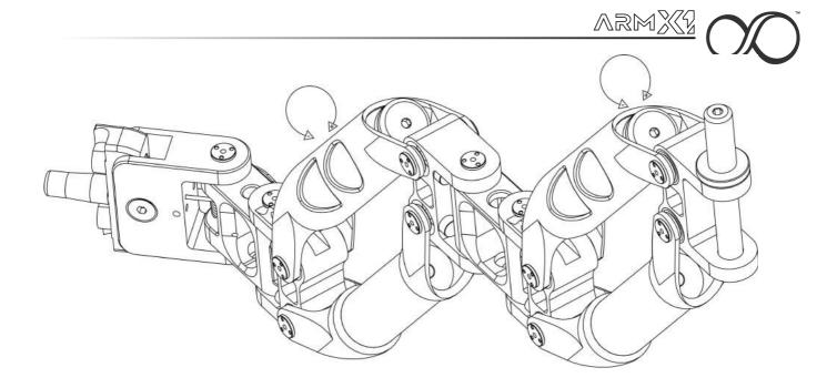
7. Avvitare la vite di regolazione del precarico fino ad allineare il piattello della vite stessa con il primo riferimento presente nell'indicatore di precarico (come mostrato in figura)
