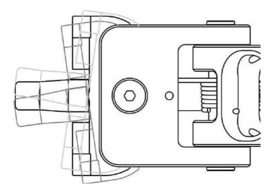
E' possibile variare l'angolazione di tilt del braccio SmartCAM ARM X1 grazie alle due viti presenti nel mating block. Tale regolazione è strettamente correlata alla postura dell'operatore.
