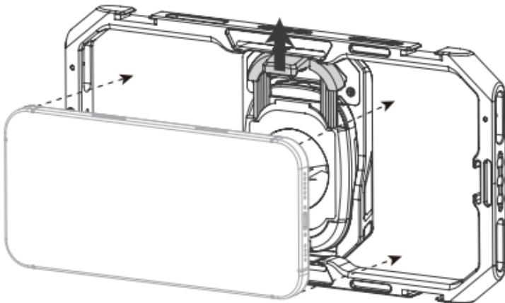
**(5) 手机适配：**当适配不同型号的手机时，为确保手机按键不被遮挡且手机始终处于拓展框中心位置，可用随产品附赠的内六角扳手松开横向调节螺丝并左右滑动夹持柱，直至手机居中且手机夹不遮挡手机按键。
