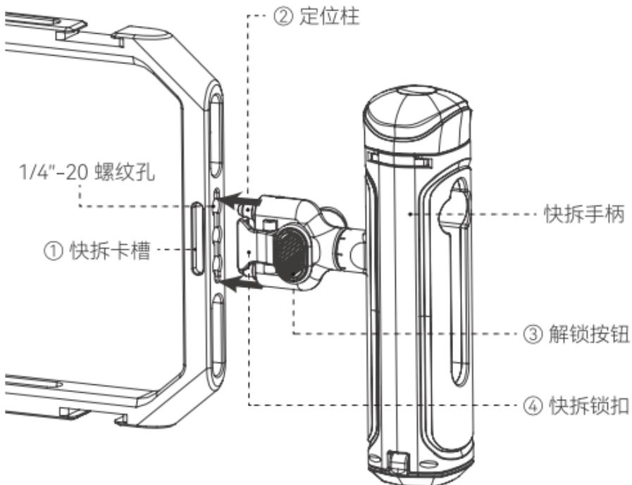
※**快拆解锁：**双面按压上图中解锁按钮③，即可实现快拆机构解锁。
