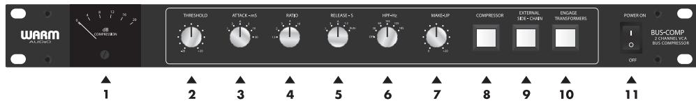
**1. ANALOG dB METER** mit Nadelkalibrierung Dieses Messgerät zeigt die Stärke der Komprimierung an, die auf Ihr Audio angewendet wird. Die Zählnadel kann leicht auf Null kalibriert werden, indem man die kleine, flache Einstellschraube, die sich direkt unter dem Zähler befindet, langsam dreht.
