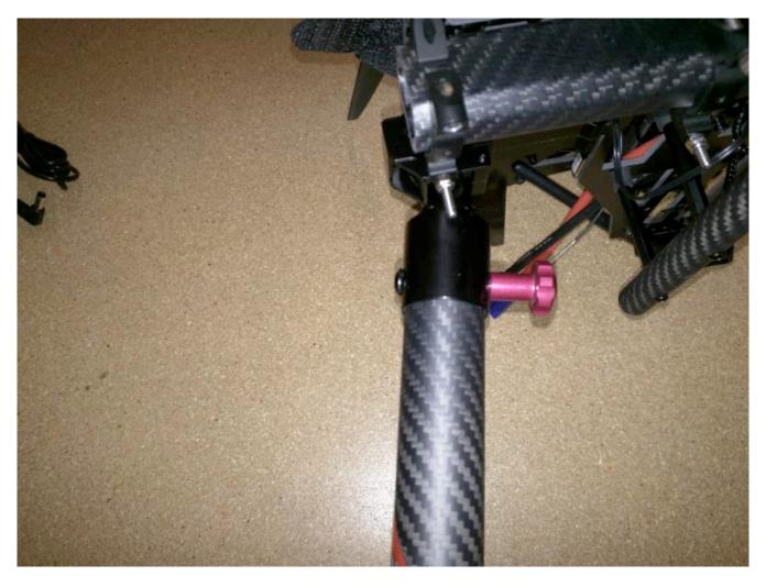
PUT THE LANDING SKIDS IN THE MOTOR ON THE COPTER HAVING THE RED RUBBER TOWARDS THE BACK.
